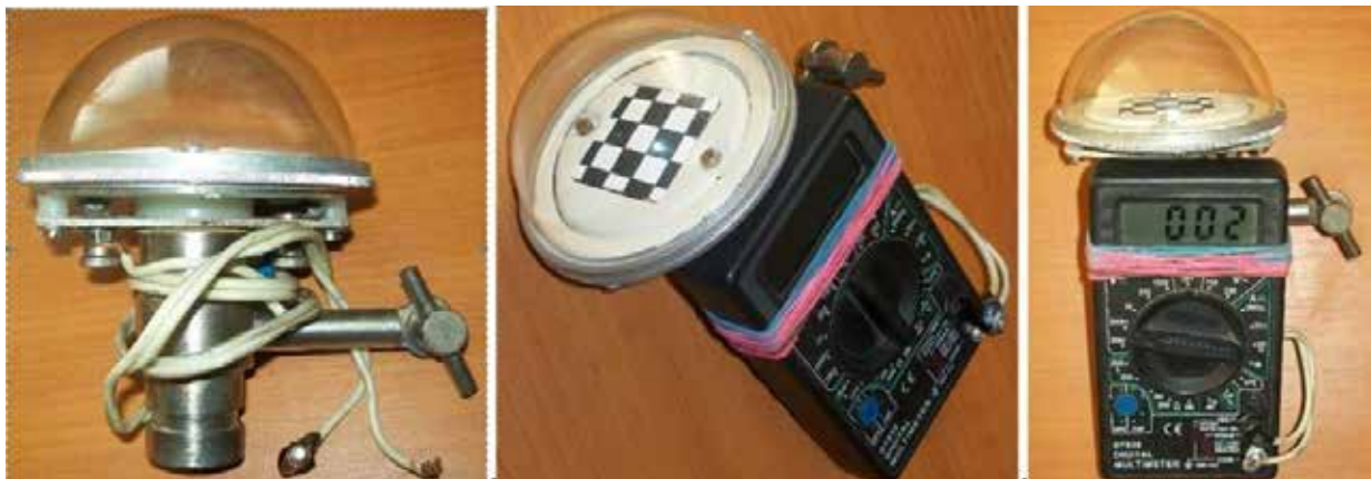
Рис. 2. Датчик піранометра окремо та сумісно з мультиметром
