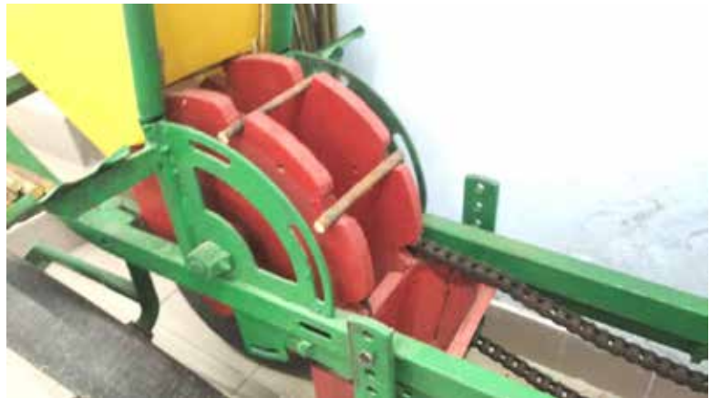
Рис. 4. Загальний вигляд польової установки, обладнаної автоматом для подачі живців у сошник
