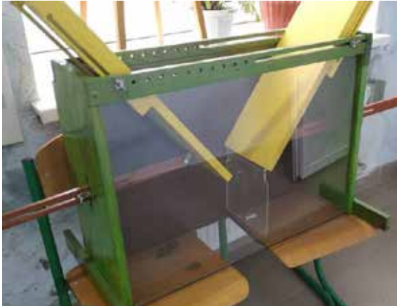
Рис. 2. Лабораторний стенд для дослідження параметрів щілинного бункера
