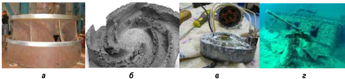
Рис. 1. Корозійне руйнування поверхні робочого колеса турбіни (а), кавітаційне знищення напрямного апарату насоса (б), пліснява на моторі-редукторі очисника фар автомобіля (в) дії молюсків на занурені у воду деталі машин (г) (Нерман V. F., 2014)
