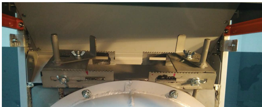
Рис. 3. Схема (а) та загальний вигляд (б) механізму регулювання вертикальних жалюзі сепаратора АЛМА-10
