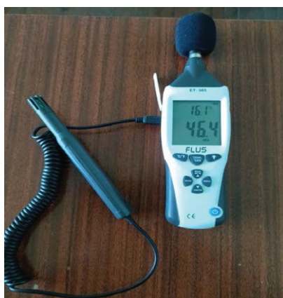
Рис. 2. Багатофункціональний тестер LUS ET-965
