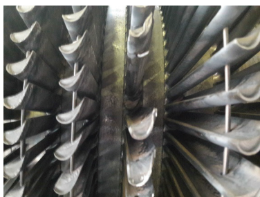
Рис. 3. Кавітаційне знищення напрямного апарату насоса
