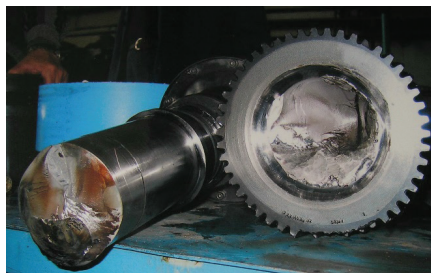
Рис. 6. Втомний злам вал – шестерні мультиплікатора
