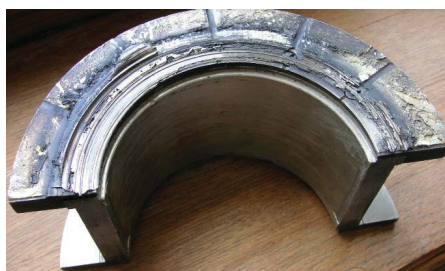
Рис. 4. Втомлювальне руйнування лопатей турбіни (а), робочого колеса насоса (б), руйнування валу насоса інерційною силою внаслідок заклинювання підшипника кочення і бабітового шару вкладишу опорного (г) і опорно-упорного підшипника ковзання (д)
