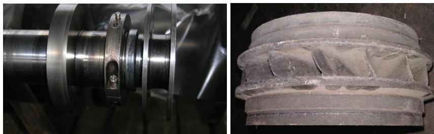
Рис. 2. Корозійно-абразивний знос підшипникових шийок валу ротора насоса (а) та гідроабразивний знос робочого колеса (б)
