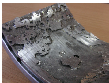
Рис. 4. Втомлювальне руйнування лопатей турбіни (а), робочого колеса насоса (б), руйнування валу насоса інерційною силою внаслідок заклинювання підшипника кочення і бабітового шару вкладишу опорного (г) і опорно-упорного підшипника ковзання (д)
