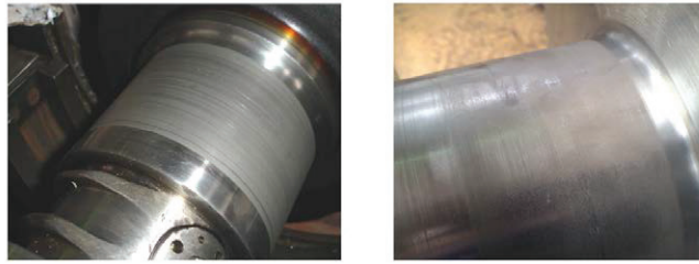
а б Рис. 7. Сліди електроерозії на шийці ротора турбіни
