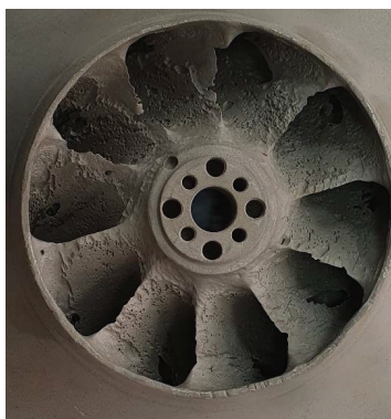
Рис. 3. Кавітаційне знищення напрямного апарату насоса
