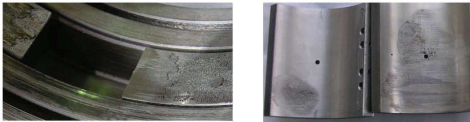
а б Рис. 9. Електроерозійне зношування опорних колодок плаваючого ущільнення (а) та опорних колодок підшипника (б)
