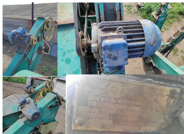
Рис. 3. Електродвигуни приводу зерноочисної машини
