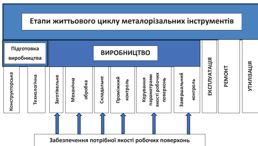
Рис. 1. Використання системи спрямованого вибору технології забезпечення необхідної якості робочих поверхонь МІ на різних етапах життєвого циклу
