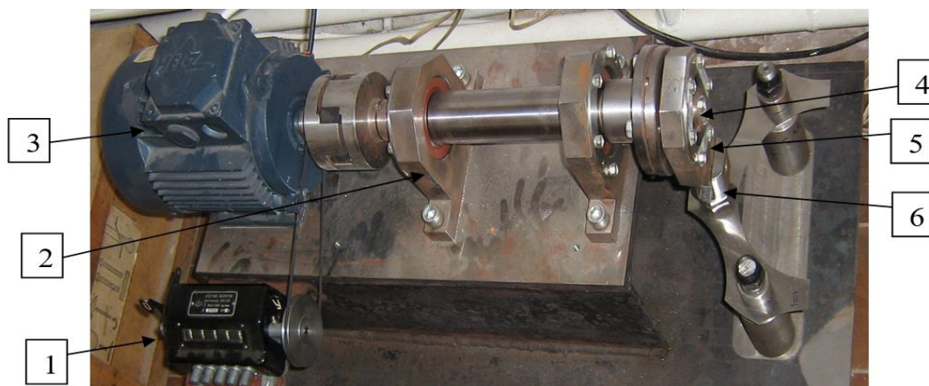
Рис. 7. Стенд для дослідження фретингостійкості: 1 – лічильник циклів; 2 – станина з підшипниковими опорами; 3 – електропривод; 4 – ексцентриковий механізм; 5 – пакет з гнучких елементів; 6 – механізм кріплення гнучких елементів.
