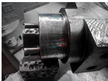
Рис. 4 – Електроіскрова обробка шийок колінчастого валу поршневого компресору ЗВШ-1,6-3/46: а – поверхня до обробки; б – процес ЕІЛ; в – поверхня після обробки
