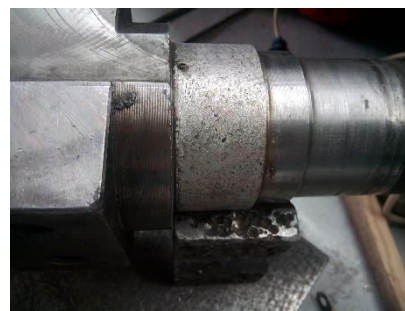
Рис. 4 – Електроіскрова обробка шийок колінчастого валу поршневого компресору ЗВШ-1,6-3/46: а – поверхня до обробки; б – процес ЕІЛ; в – поверхня після обробки
