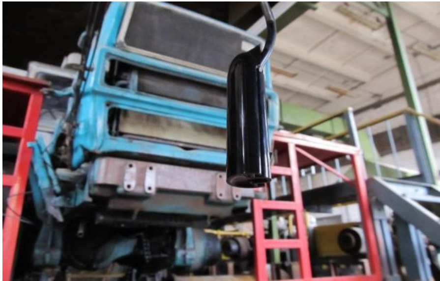
Рис. 3. Установка датчика ПВГП на тракторі Т-150К
