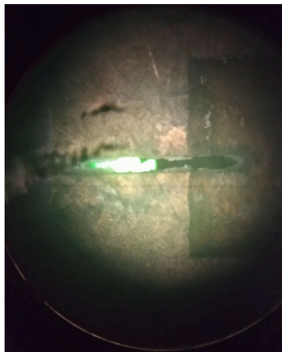
Рис. 2. Форма сопла гідравлічного розпилювача після сезонної експлуатації.
