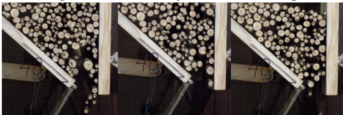
Рис. 6. Приклади утворених склепінь при вивантаженні живців енергетичної верби
