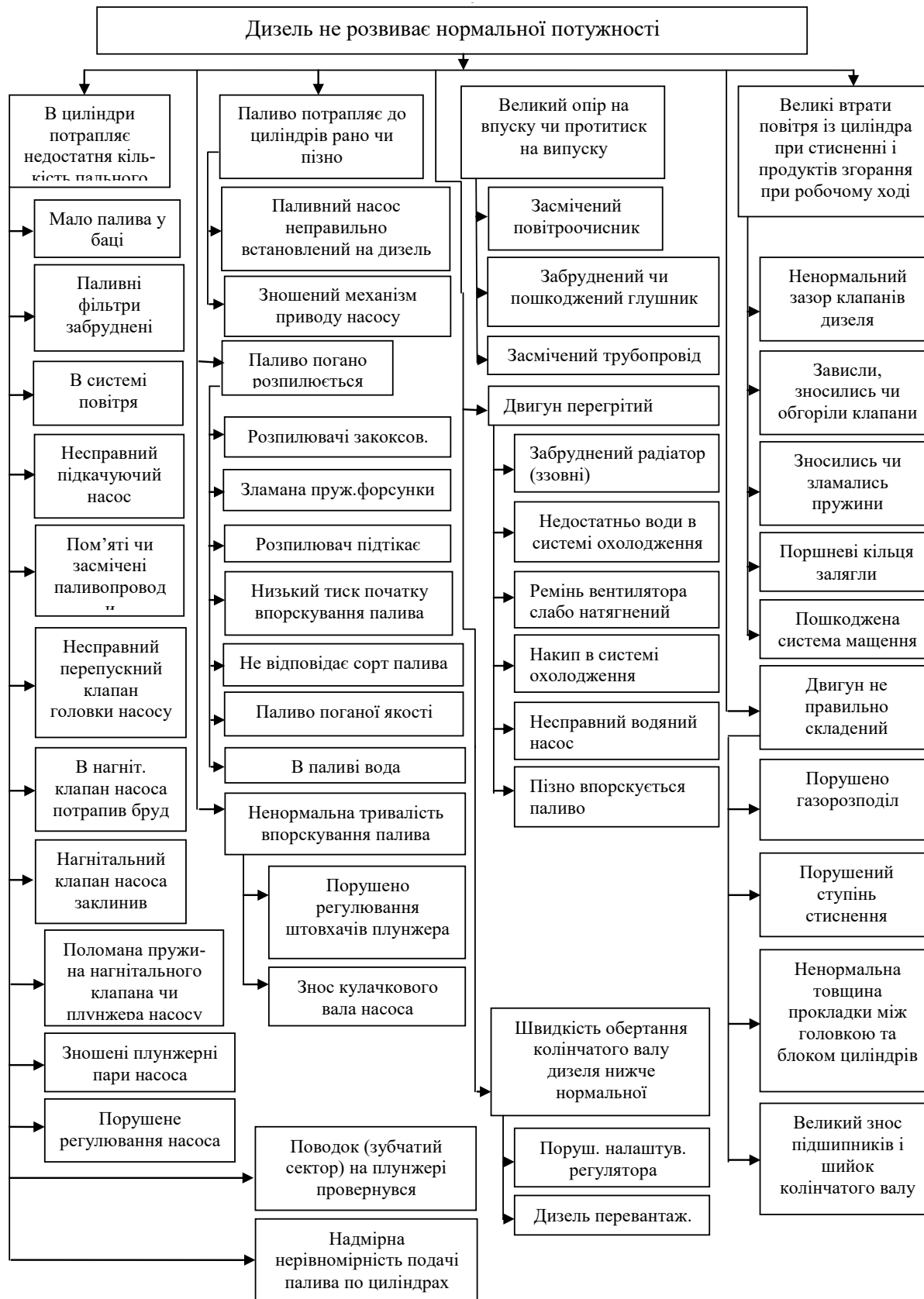
Рис. 5. Алгоритм пошуку причини зниження потужності двигуна
