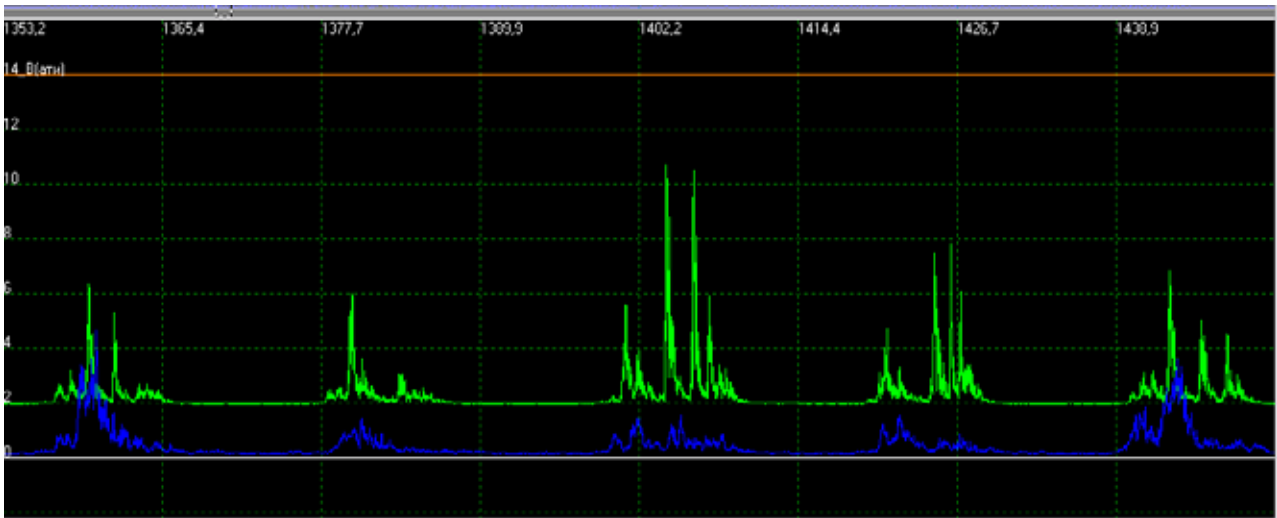
Рис. 11. Дефект приводу ГРМ 3 циліндра
