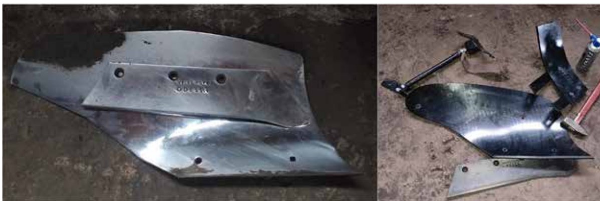
Рис. 1. А – залізний відвал; Б – композитний відвал Текроне та додаткові елементи
