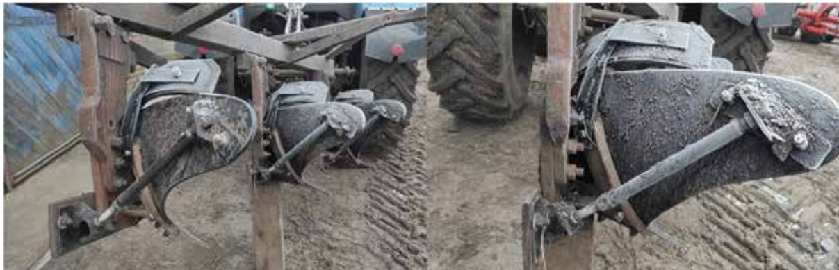
Рис. 2. Робочі органи плуга після встановлення відвалів Tekrone
