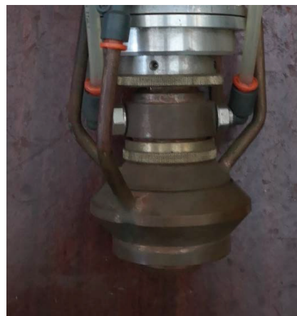
а б Рис. 1. Ескізне креслення (а) та виготовлена наплавочна головка (б)
