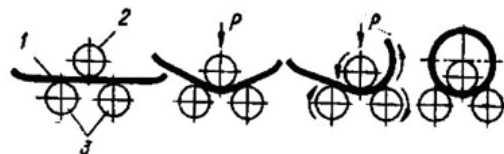
Рис. 7. Гнуття обичайки на тривалковій машині з симетричним розташуванням валків
