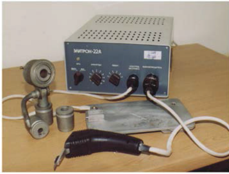
Рис. 2. Зображення установки електроерозійного легування моделі «Елітрон–22А» (а) та зразки для досліджень (б)
