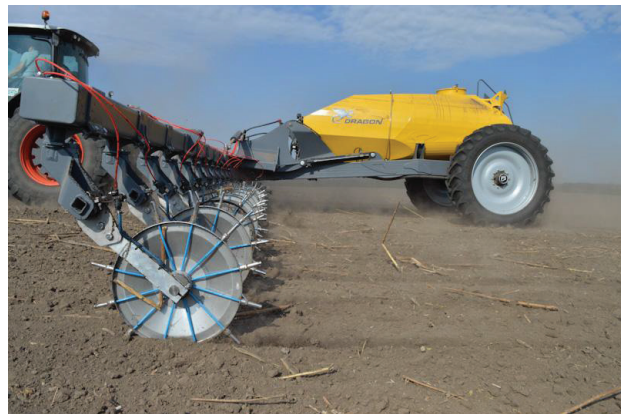
Рис. 2. Вигляд ін'єкційних робочих органів у польових умовах на прикладі знаряддя «Dragon» (Radionov, 2020)
