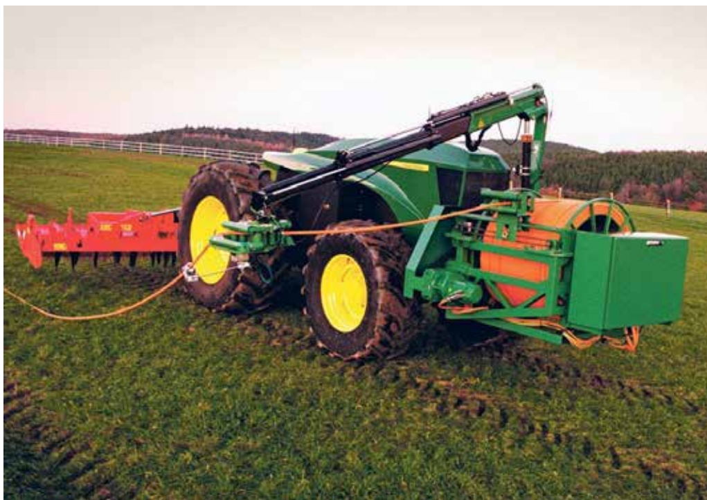
Рис. 7. Трактор John Deere 6210R з електричним двигуном який живиться електроенергією через кабель
