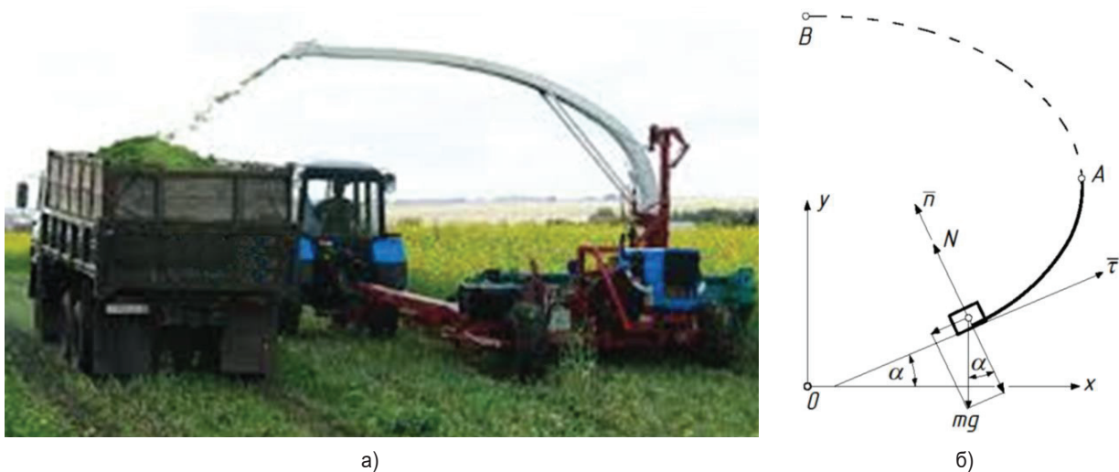
Рис. 1. Графічні ілюстрації до руху частинки по кривій лінії – осі силосопроводу: а) транспортування подрібненої маси у транспортний засіб; б) схема руху окремої частинки і прикладені до неї сили
