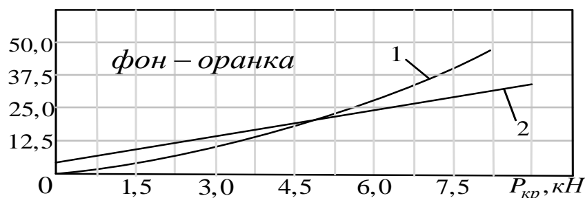
Рис. 4 Порівняння результатів теоретичної та експериментальної оцінки відносного буксування ведучих коліс на деформованій поверхні: 1 - експериментальні результати; 2 - результати за формулою (16).
