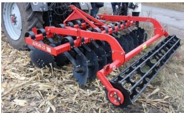
Рис. 1 – Загальний вигляд дискової борони-луцильника ДукаТ-2,5
