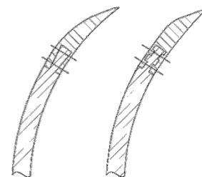
Рисунок 5 - Схема фіксації наконечника на виточенні диска.
