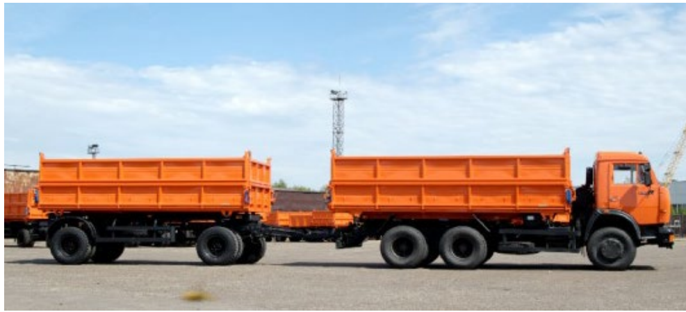
Рис.2. Автопоїзд КамАЗ – 45143-11+ НЕФАЗ-8560-02
