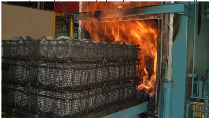
Рис. 1. Процес традиційної цементації методом хіміко-термічної обробки [3].
