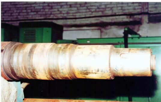
Рис. 1. Корозійно-абразивне зношування підшипникових шийок валу ротора насоса ЦНС-180
