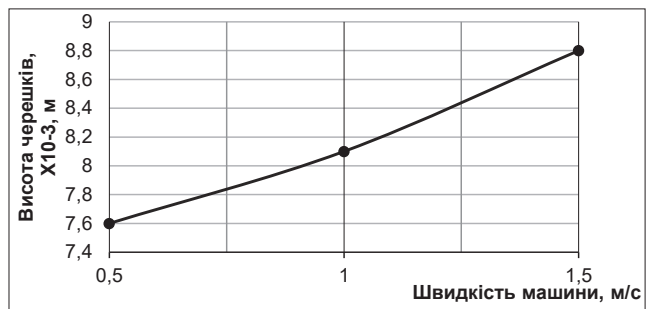
Рис. 7. Залежність висоти черешків бадилля від поступальної швидкості руху машини при кутовій швидкості ножів – 1500 хв-1
