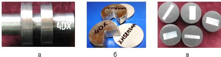
Рис. 3. Зразки для дослідження параметрів якості покриттів: а – круглі зразки, б – вирізані сегменти, в – шліфи
