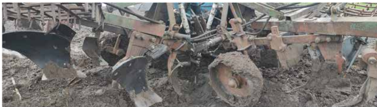
Рис. 3. Композитні відвали при роботі на вологих ґрунтах
