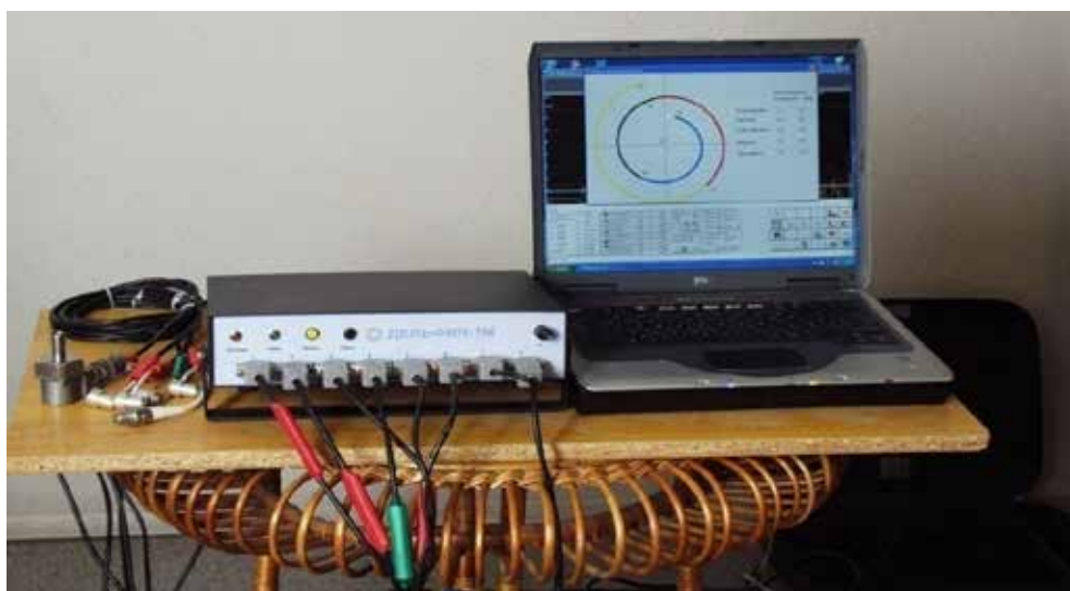
Рис. 1. Стенд віброакустичної діагностики «Дельфін-1М»
