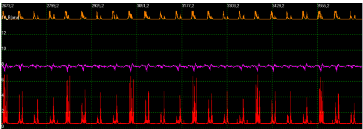
Рис. 12. Дефект приводу ГРМ 3 циліндра
