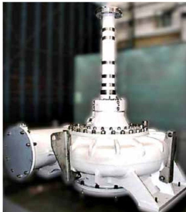
Рис. 2. Обладнання підготовлене АТ «СМНПО – Інжиніринг» для реконструкції та модернізації існуючих НС в Республіці Таджикистан: а – конструктивна схема електронасосного агрегату ЦВН 22600-9; б – типовий загальний вигляд насоса ЦВН 22600-95 (без електроприводу)
