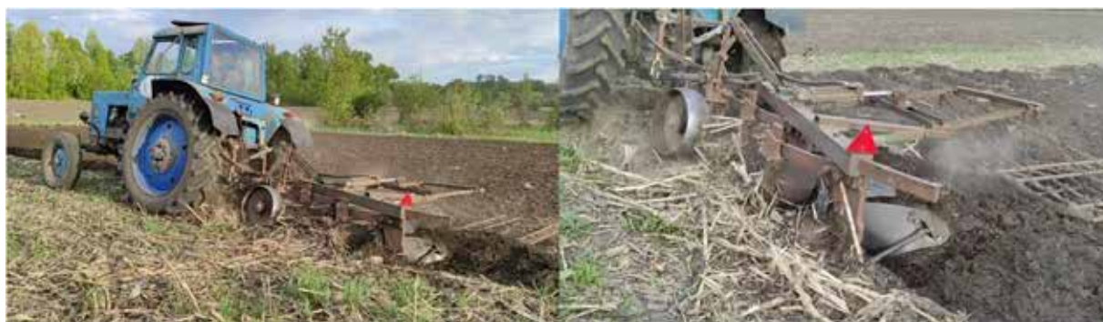
Рис. 6. Використання плуга з композитними відвалами з великою кількістю поживних залишків
