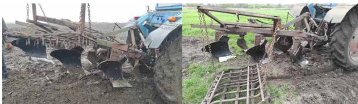
Рис. 5. Випробування композитних відвалів на вологому та сухому ґрунтах
