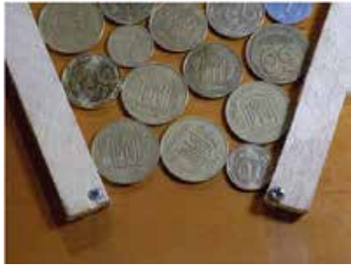
Рис. 3. Приклади утворених склепінь при вивантаженні циліндричних тіл на площині
