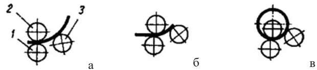
Рис. 5. Гнуття обичайки на машині з асиметричним розташуванням валків
