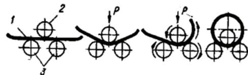
Рис. 7. Гнуття обичайки на тривалковій машині із симетричним розташуванням валків
