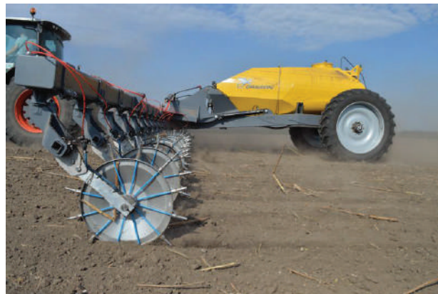
Рис. 2. Вигляд ін'єкційних робочих органів у польових умовах на прикладі зняряддя «Dragon» (Radionov, 2020)
