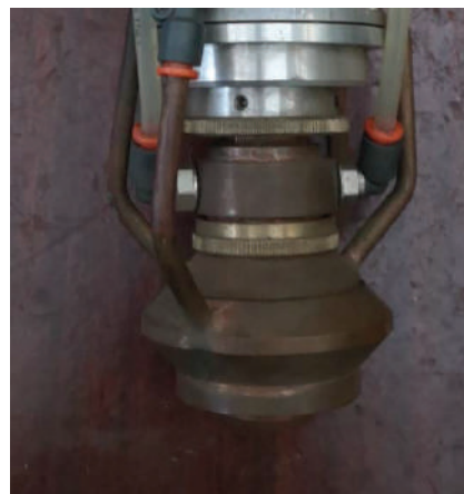
Рис. 1. Ескізне креслення (а) та виготовлена наплавочна головка (б)
