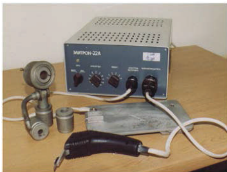
Рис. 2. Зображення установки електроерозійного легування моделі «Елітрон–22А» (а) та зразки для досліджень (б)
