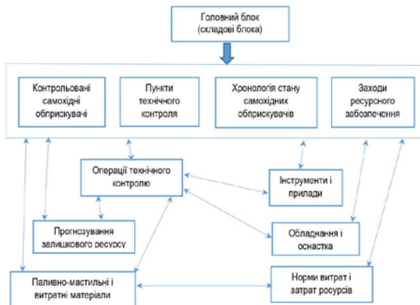
Рис. 1. Структура системи інформаційного забезпечення технічного контролю самохідних обприскувачів
