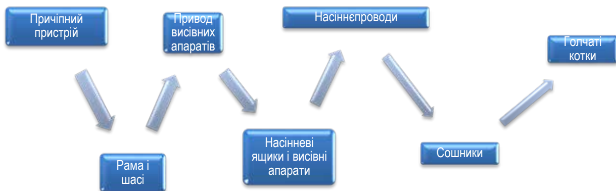
Рис. 2. Схема посівної машини з послідовним з'єднанням елементів
