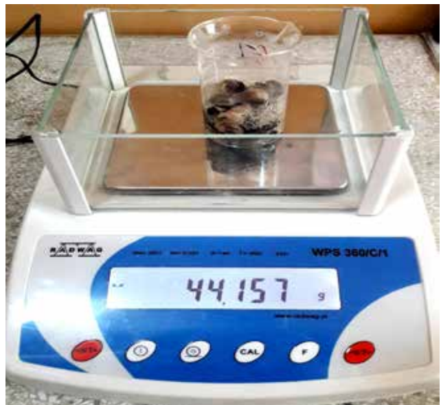
Рис. 2. Наважка середньої проби м'яса на вагах лабораторних
